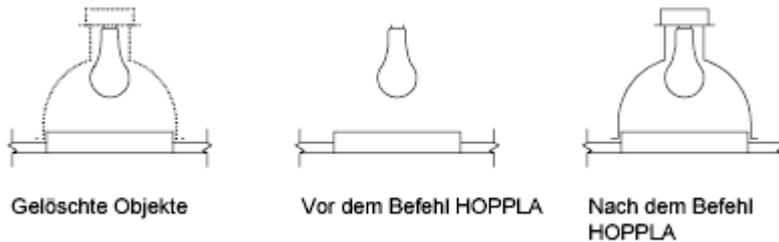
Sie können den Befehl HOPPLA auch nach BLOCK oder WBLOCK verwenden, da diese Befehle die ausgewählten Objekte nach dem Erstellen eines Blocks löschen können.
